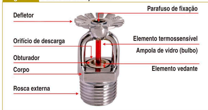
Figura 1 Partes de um sprinkler
